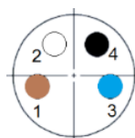
выход NPN NO / NC с разъемом M8, 4-pin, штекер "папа"
