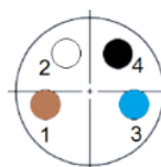
2 выхода PNP NO с разъемом M8, 4-pin, штекер "папа"
