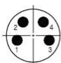
Приемник с разъемом M8, 4-pin, штекер "папа" PNP NO / PNP NC / NPN NO / NPN NC выход
